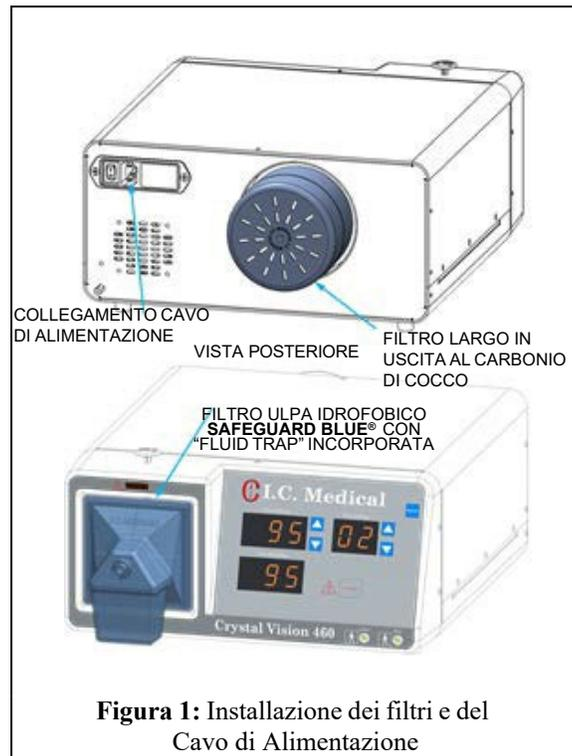
**Figura 1:** Installazione dei filtri e del Cavo di Alimentazione
